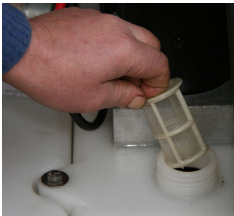
Fig. 2-14 Vérification du niveau d'huile
