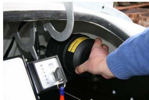
Fig. 2-10 Démontage du couvercle de filtre à air
