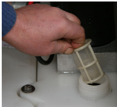
Bild 2-14 Pegelkontrolle der Hydraulikflüssigkeit
