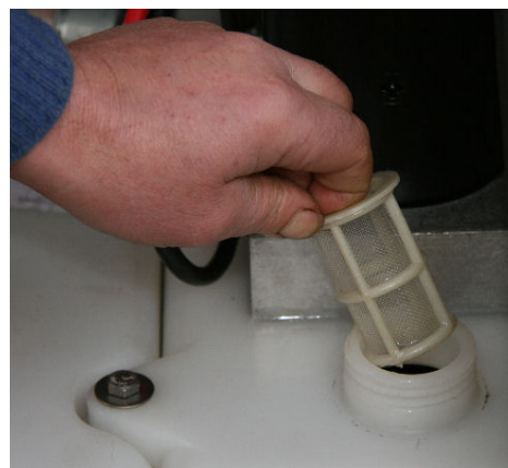
Afb. 2-14 Hydraulische vloeistof peiling
