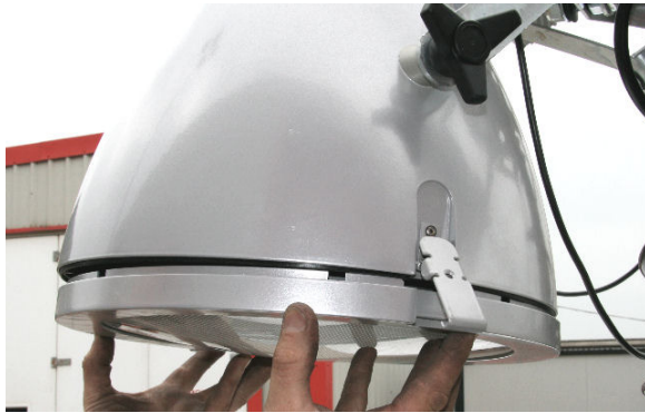
Fig. 3-1 Clips de fixation de la lentille
