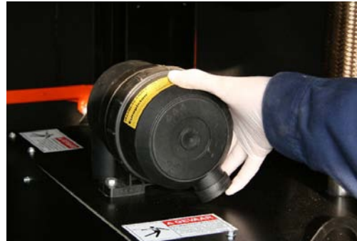
Fig. 2-10 Démontage du couvercle de filtre à air
