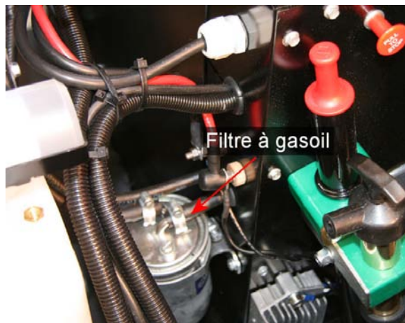
Fig. 2-5 Filtre à gasoil fixe
