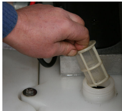
Bild 2-14 Pegelkontrolle der Hydraulikflüssigkeit
